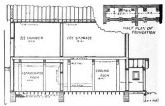
Fig. 374—LONGITUDINAL SECTION OF COLD STORAGE HOUSE
