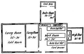
Fig. 276—FLOOR PLAN OF CHEESE FACTORY
