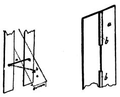
Fig. 366—VENTILATOR HOOK
