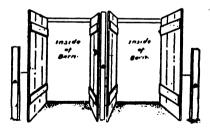
Fig. 368—ARRANGEMENT OF DOUBLE DOORS
